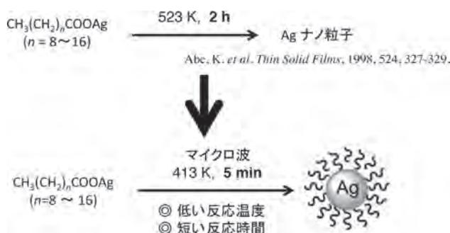
図2 マイクロ波照射下における銀ナノ粒子合成反応
