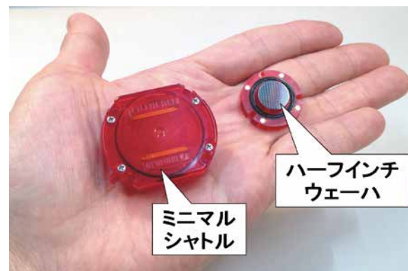
図2 ミニマルシャトル(左の赤い容器)とハーフィンチウェーハ
