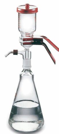
ガラス製溶媒フィルタ/デガッサ、3150-0577
