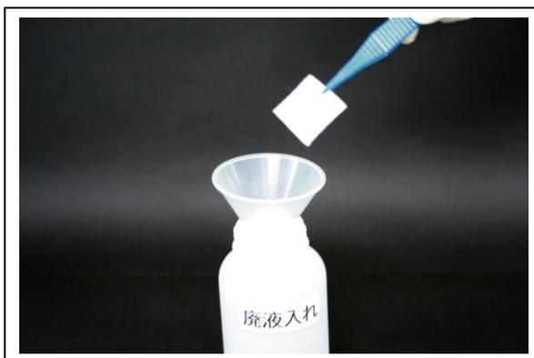
5. 2. の液をロートに流し入れ、ビーカー内を蒸留水で数回洗い流します。さらに、脱脂綿全体を蒸留水で3回以上洗います。
