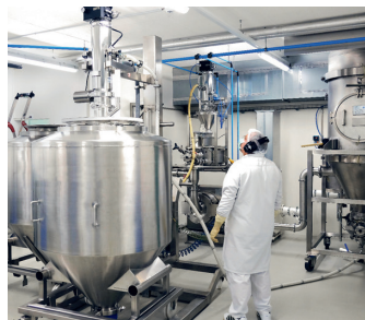
▲800 kg までスケールアップ 可能な粉末培地製造設備
