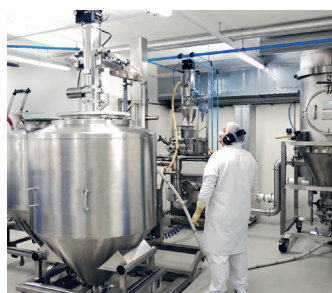
▲800 kgまでスケールアップ 可能な粉末培地製造設備
