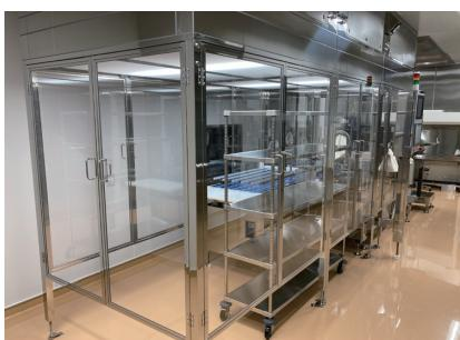
▲ RABS（内部に自動充填装置を設置）
