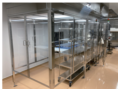
▲ RABS（内部に自動充填装置を設置）
