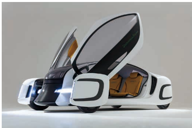
図4 コンセプトカーItoPの写真。ItoPのボディ部であるモノコックフレームにはシクロデキストリンを用いたポリロタキサンが含まれている。
