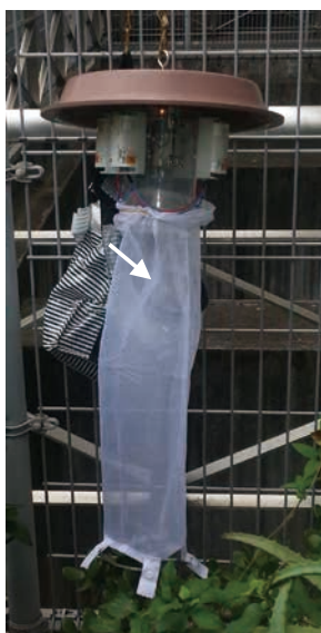
図10 蚊捕集用ライトトラップ ドライアイス(→)を袋に入れ、一晩電球を点灯させる。引き寄せられた蚊は回転するプロペラによる風圧により白い捕集網に捕獲される。電池式で稼働する。
