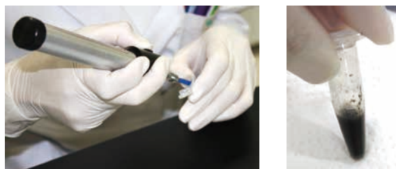
③ マイクロマルチミキサーを動かし、攪拌ベッセルで蚊の形が無くなるまで潰す(約1分間)。 ④ チューブを遠心分離し、上清140 μLからRNAを抽出する。
