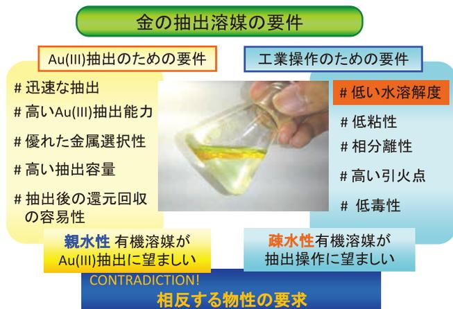
図6 Au(III)抽出溶媒の抽出能力と工業要件は相反する
