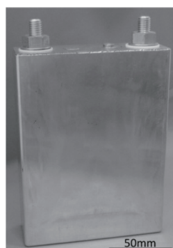
図2 27 Ah級ナトリウム二次電池の外観(左)および充放電曲線(右) 10)
