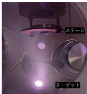
図3 ロングスロースパッタ成膜装置におけるプラズマ生成時の成膜室
