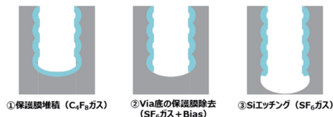
図2 ボッシュプロセスによる深堀エッチング技術の概念図
