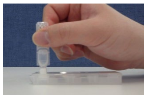
②抽出展開液ボトルの先端を ふき取り部にトントンと押し付ける
