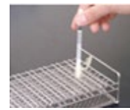
④前処理したろ液にテストストリップを浸す
