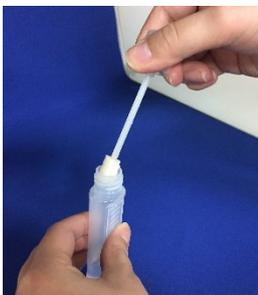
キャップを本体から取り外し、ボトル中央部で余計な水分を取り除きます。
