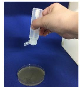
キャップの上栓を跳ね上げ、培地や検査キットに検体希釈液を滴下します。
