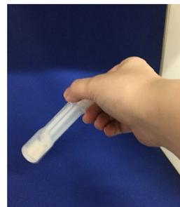
拭き取り後、キャップをボトルに戻し、容器を左右に振り、スワブに付着した菌などを希釈液中に均一化させます。
