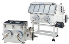
バキューム型と言っても真空状態で使うわけではありません。予めグローブボックス内部を真空ポンプでしっかり排気してからガス置換できるので、効率良く高レベルの作業雰囲気にすることが出来ます。
