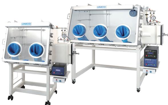
グローブボックス内部に置換ガスをオーバーフローして低酸素、低水分の作業雰囲気をつくります。
