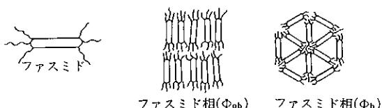
う提案している(形がよく似た昆虫の名に由来)<sup>10)</sup>。メソーゲンII-3Aは、新しい中間相構造をもった2種類の液晶相Φ<sub>ob</sub>とΦ<sub>h</sub>を示す。液晶相では、分子は重なり合ってカラムを形成し、炭化水素鎖は融解状態である。カラム配置は、通常のD相とは異なり、Φ<sub>ob</sub>相ではラメラ状に、Φ<sub>h</sub>相では、リオトロピック液晶のヘキサゴナル相に類似した配列が考えられている。
