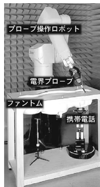
図1 SAR測定システム
