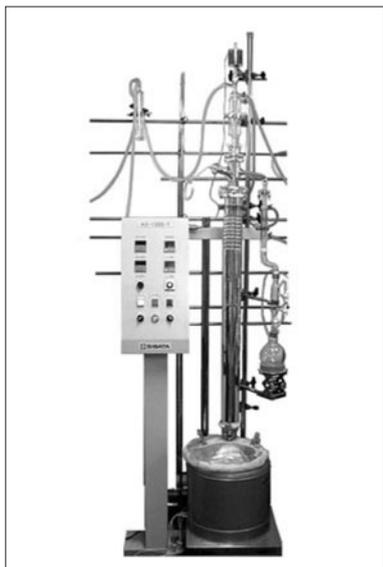
図5 2L精密蒸留装置
