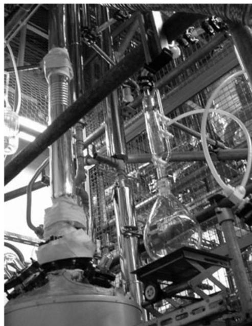
図2 20L精密蒸留装置
