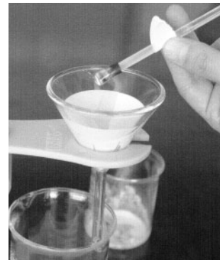
写真5. あらかじめちぎっておいたろ紙片で、ポリスマンに付いた沈澱をふき取り、合わせて処理する
