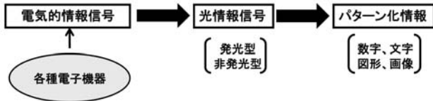
図2 電子ディスプレイデバイスの機能 (松本正一, 電子デバイス, p.1, オーム社 1995)
