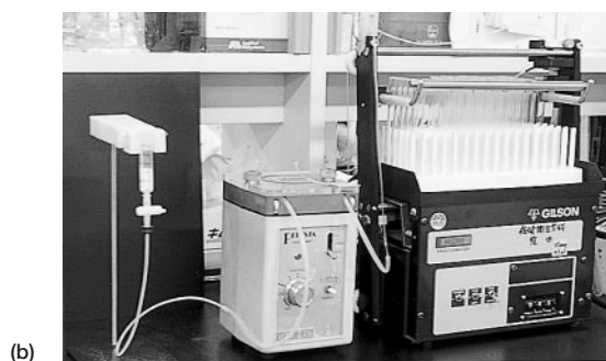
図2 球状ピロリン酸マグネシウムカラムによる抗体精製。当研究室では注射用シリンジに充填して(a)、フラクションコレクターに接続している(b)。
