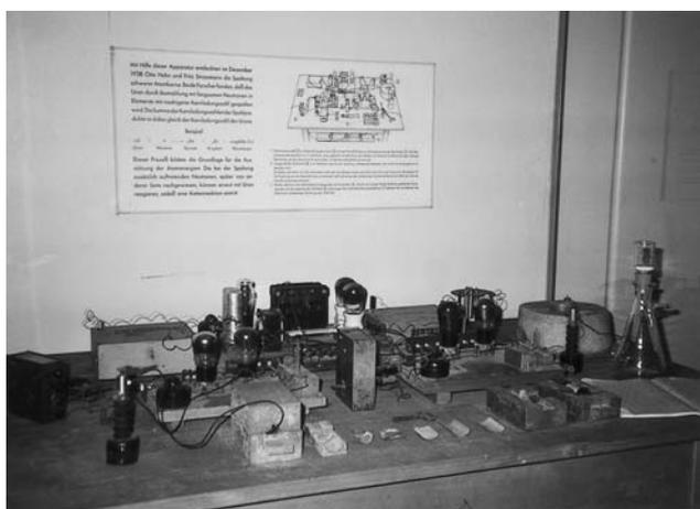
ミュンヘンのドイツ博物館に展示されているハーンとシュトラスマンが1938年に初めてウラニウムの核分裂に成功したオリジナルの核分裂装置
