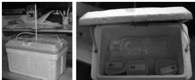
図2 自家製簡易培養器 中央に温度計を差してある。保温材として、ペットボトルにお湯を入れて使用した。
