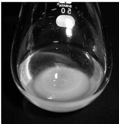
図4 反応溶液から析出した *fac*-Ir(ppy)<sub>3</sub>
