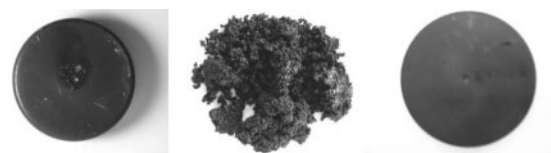
Fig. 1 合成した再生プラスチック。メタノール分解のもの(左) DMAP存在下で分解したもの(中) DMAP存在下で分解したモノマーを水洗してから樹脂化したもの(右)
