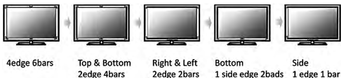
図8 LCD-TV用エッジ・ライト型LED-BLUの変遷
