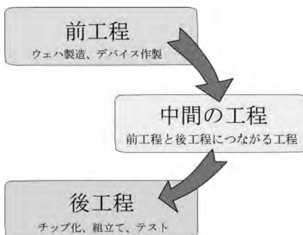
図1 半導体デバイス製造工程
