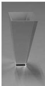
図3 反射鏡型集光太陽電池の集光・発電の概念図
