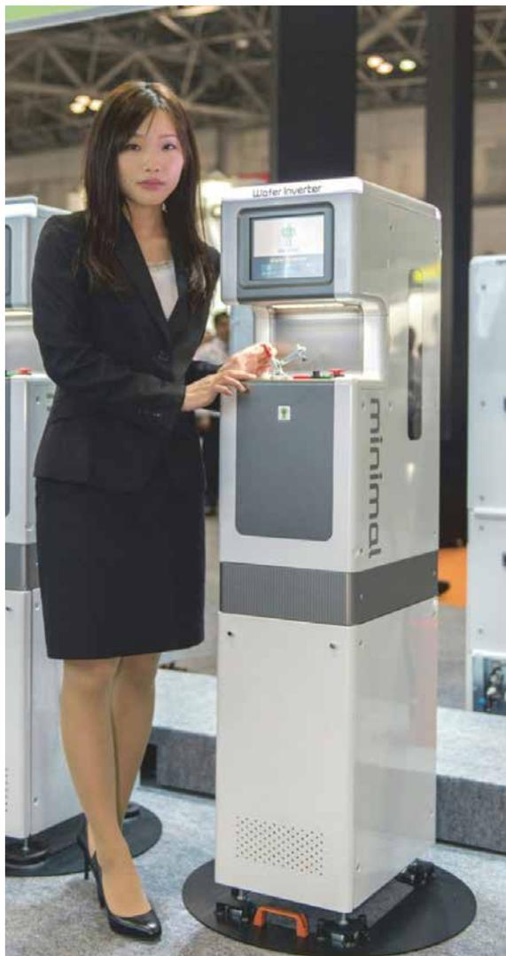
図3 人サイズのミニマル装置(注:1プロセス1装置)
