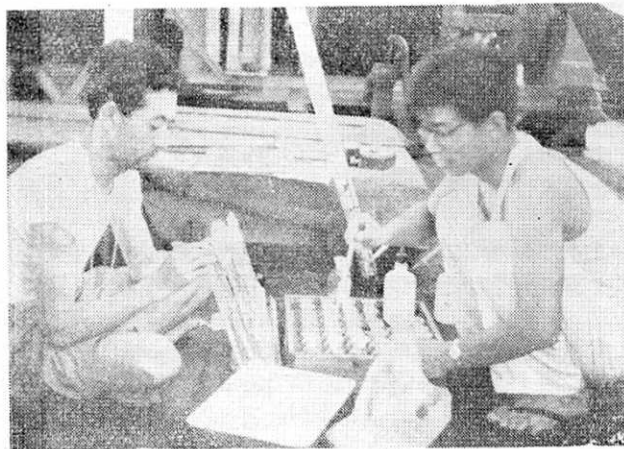
甲板上で海水中のリン酸含量の分析 種々の分析を行いこの結果より南洋の海水および海流の状態をつかみ放射能含量について調査を加えるのである
