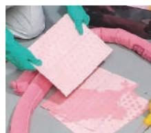
ソックスで漏洩した液体を囲み、内側にたまった液体を吸収します。
