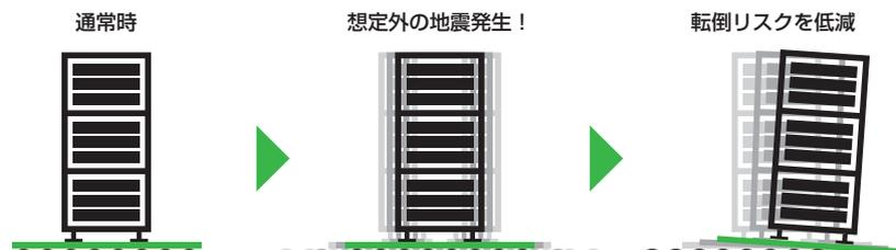
ミューソレーターは、製品自体に可動限界はなく、可動範囲（＝安全性能）を自由に計画可能。万が一、計画した可動範囲を超えても、落差はわずか 1.3mm のため転倒・破損リスクは最小限に抑えられます。
