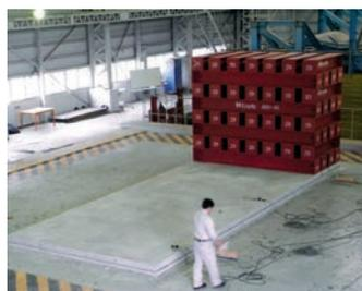
偏在荷重による振れ振動実験
