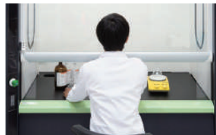
庫内の作業スペースは屋外排気式ヒュームフードと同様に広く使いやすい構造
