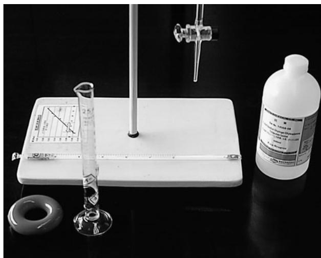
写真1 メスシリンダー転倒防止用リング状重りのセット前
