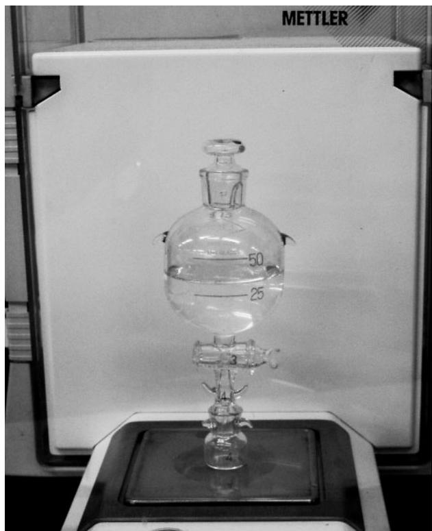
図3 質量ビュレット(質量測定中の写真)
